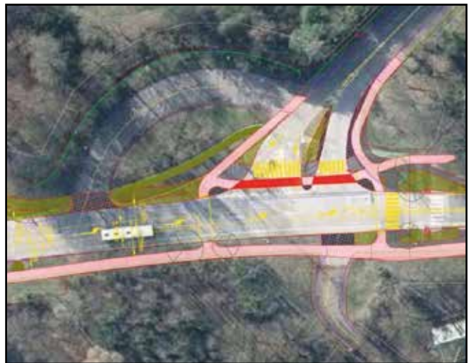
FOTO AWV - Een impressie over hoe het kruispunt wordt heringericht met afgescheiden fietspaden, nieuwe oversteekplaatsen en verkeerslicht.
